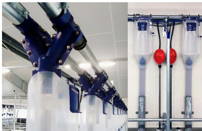
Volumendosierer mit zwei Futterrohre und Futterkomponenten      Volumendosierer 7,5 l.
