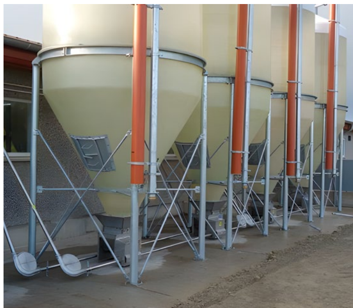
Optagerstationer under udendørs siloer.
